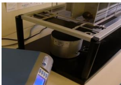
9. ábra Dinamikus plantáris eszteziométer (DPA)
