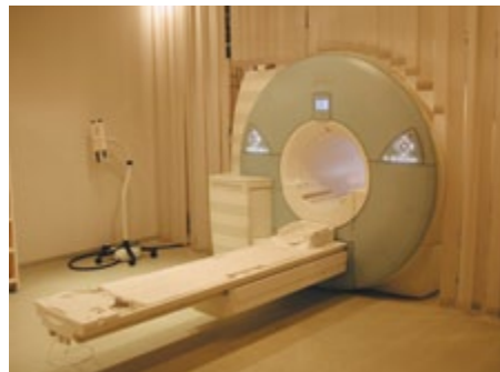
28.4. ábra Magas térerejű szupravezető mágneset tartalmazó zárt MR-berendezés (1,5T Siemens Avanto, Kaposvári Egyetem Egészségügyi Centrum)
