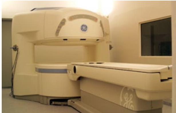
28.1. ábra Alacsony térerűjű permanens mágneset tartalmazó nyitott MR berendezés (0,35T GE Ovation, Kaposvári Egyetem, Egészségügyi Centrum)
