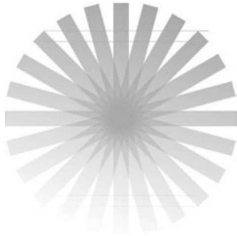
26.14. ábra Pont elmosódottsága egyszerű visszavetítéses algoritmus esetén
