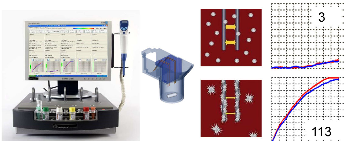
16.8. ábra: Impedanciás aggregométer és mérési elve
