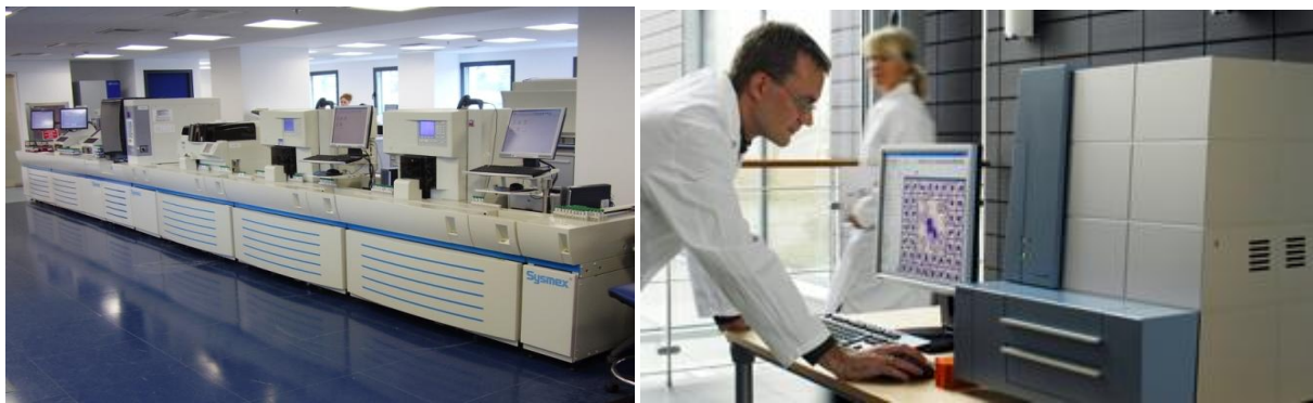
2.ábra: kenetfestő és értékelő „Cell Image Analysis” rendszerrel kiegészített vérvékp automata sor („Sysmex utca”)
